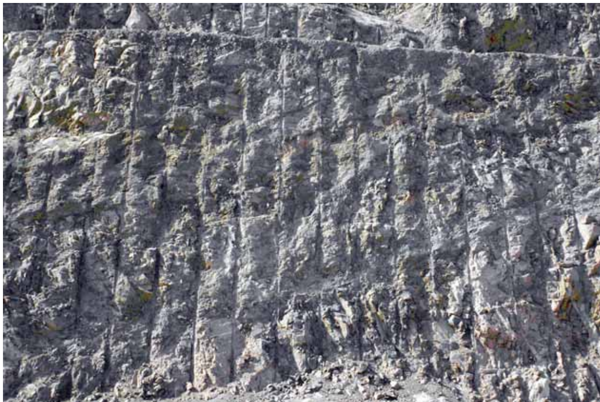
شکل ۶- تصویر دیواره نهایی و اثر داغ چال به جا مانده از آتشباری به روش پیش شکافی در دیواره نهایی (معدن آهن چادرملو)
